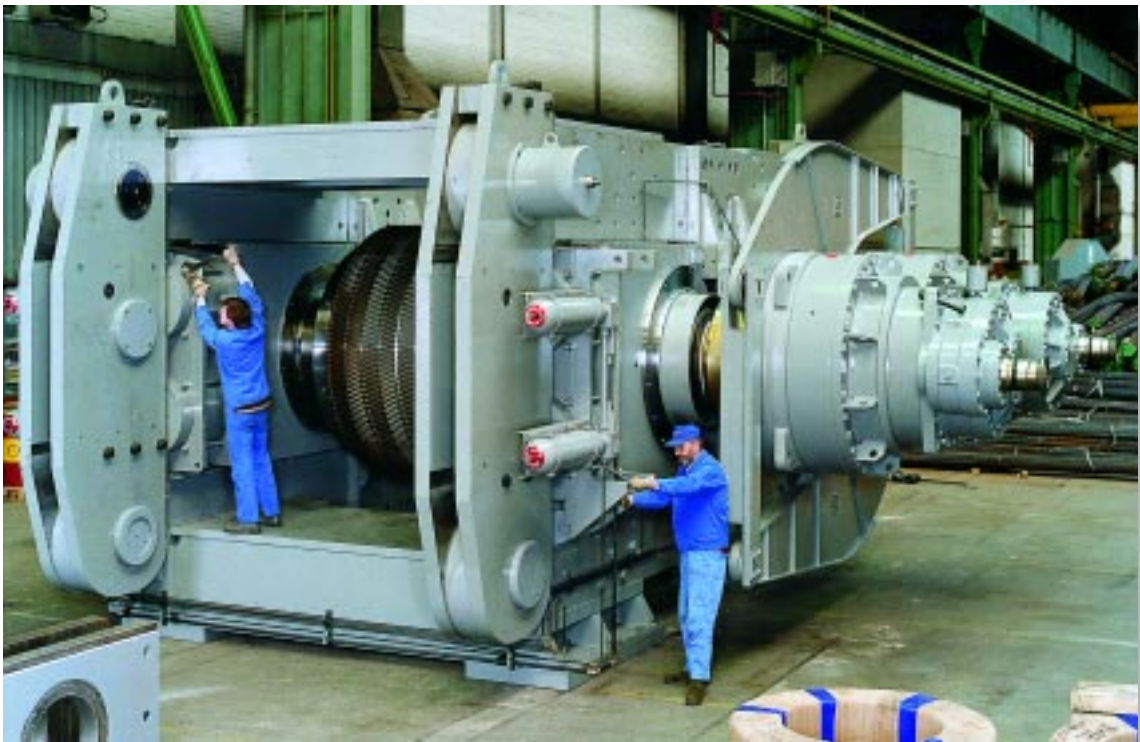
Walzenpresse für die Hochdruck-Zerkleinerung von Zementklinker Roller press for high-pressure grinding of cement clinker
