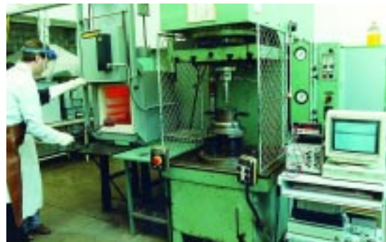
Stempelpresse für Heißbrikkettier-Versuche Piston press for hot briquetting tests
