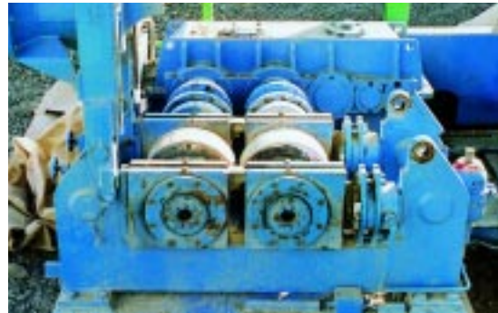
Verschleißprüfstand für neue Werkstoffe Abrasion test bench for new materials
