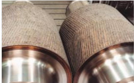
Zerkleinerungswalzen mit Auftragschweißung Comminution rollers with welded hardfacing
