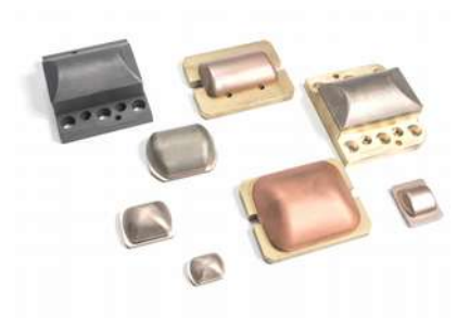
Verschiedene ECM Werkzeugelektroden
